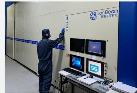
广新离子束超薄无胶柔性覆铜板生产设备
